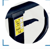
Bedienhebel in Deichsel integriert mit Drei Positionen (Absenken – Neutral – Hub)
