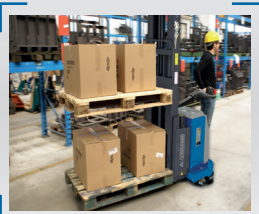
Doppel Paletten Beförderung und Einlagerung, auf Gabel und Stabilisatoren.
