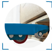
Paletten Eingabelung Zusatz- Hilfsrollen für leichtes Paletten Ein-Ausfahren.
