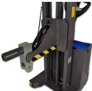
**Material:** pulverbeschichtete Aluminium-/ Stahlkonstruktion
